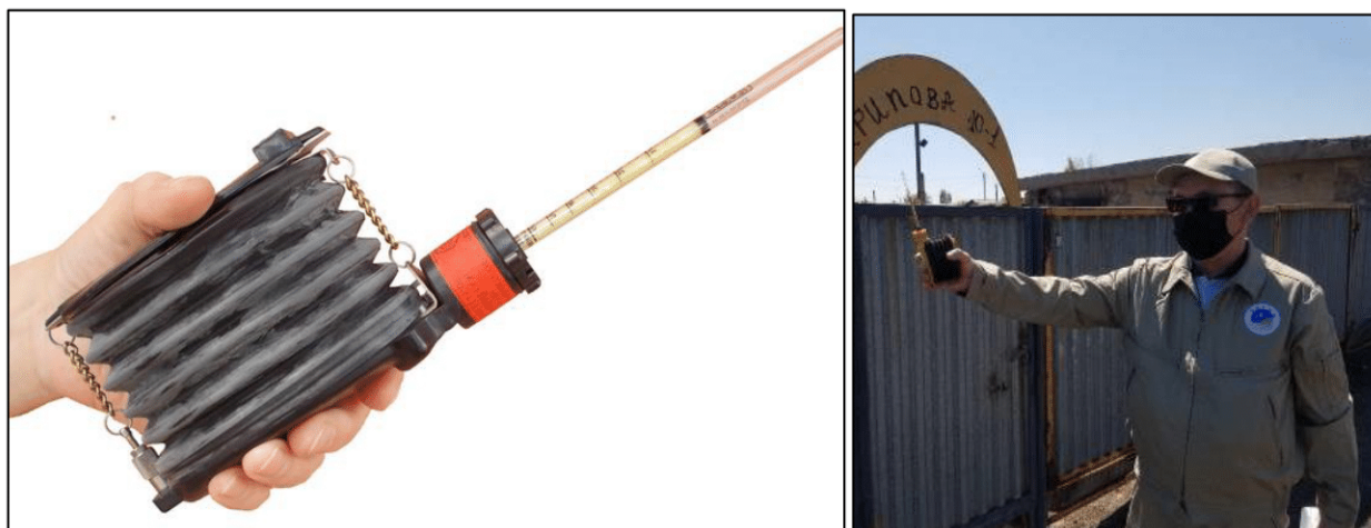
Рисунок 3 – Аспиратор АМ-5 с индикаторными трубками и пример измерения
