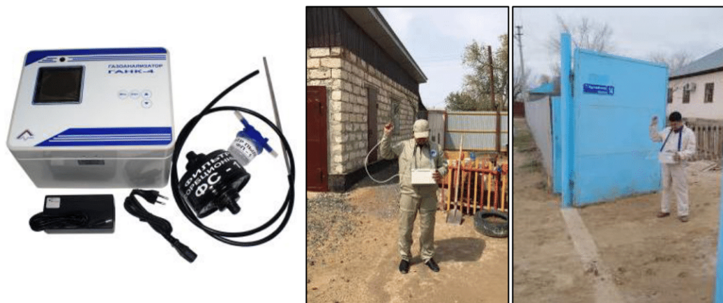
Рисунок 2 – Переносной газоанализатор ГАНК-4 и измерения в населенных пунктах
