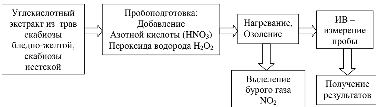
Рисунок 34 – Схема определения содержания фоновых концентраций тяжелых металлов в углекислотных экстрактах из трав скабиозы бледно-желтой, скабиозы исетской методом инверсионной вольтамперометрии
