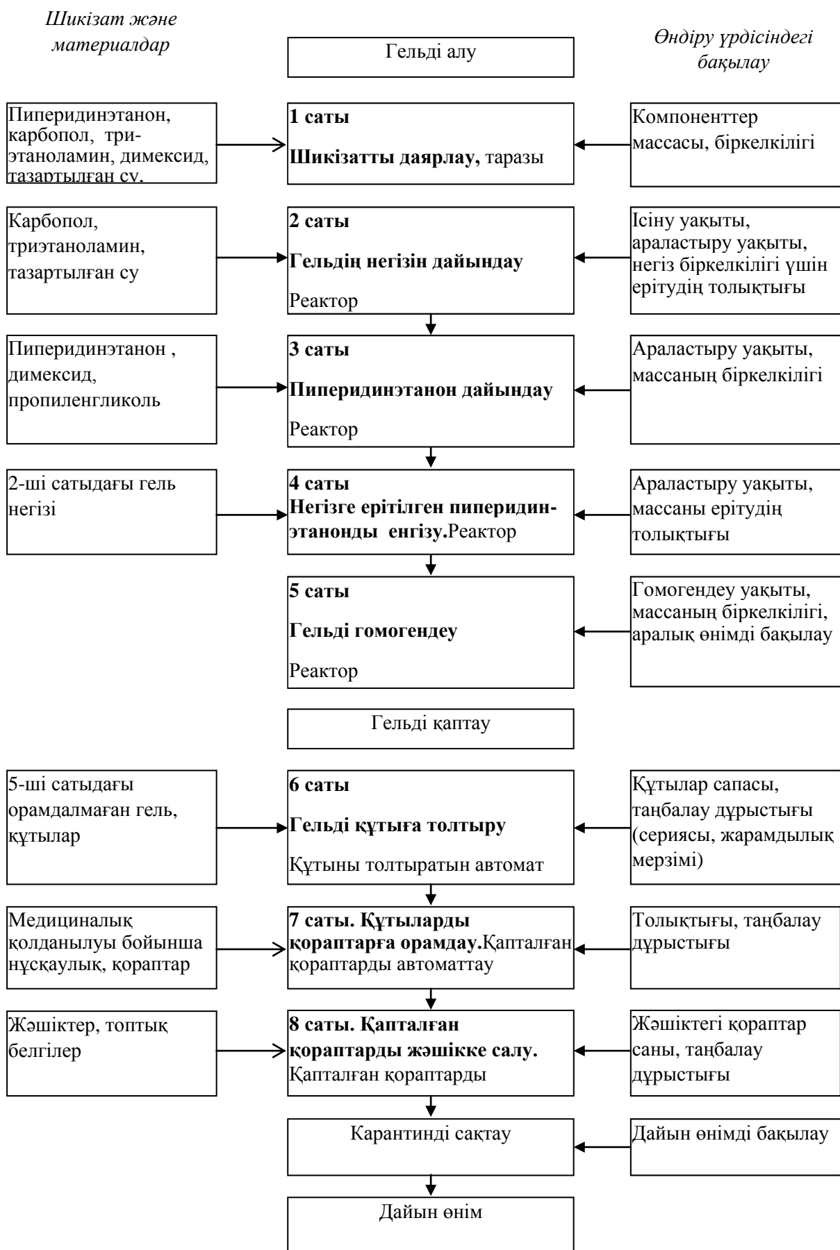
Сурет 27 – «Anticandid» шартты атаулы гелін дауындаудың технологиялық үрдісінің блок-сызбасы
